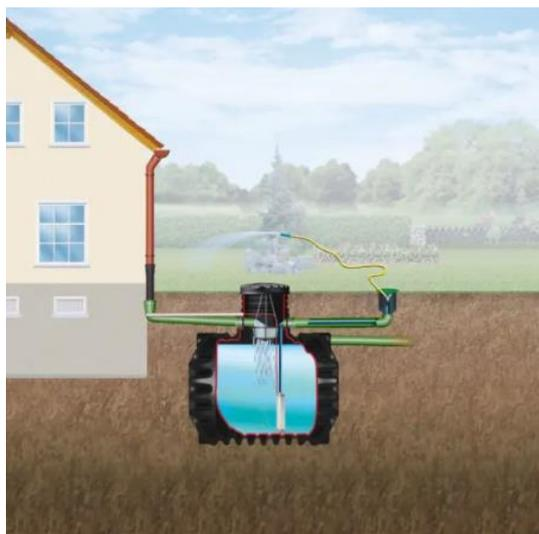
Il faut enterrer la cuve et installer une pompe électrique immergée.
